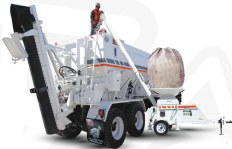
Recarga con super sacos de 2 tons.
